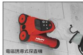
電磁誘導式探査機
